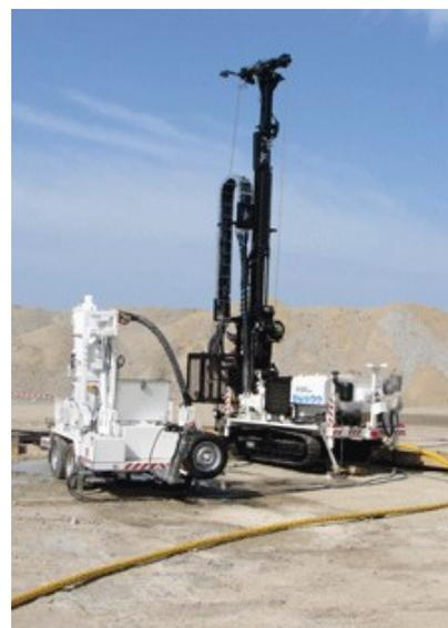
**Figure 1 : Foreuse à circulation inverse**
