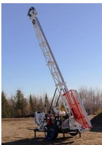
**Figure 2 : Foreuse pour carottage**
