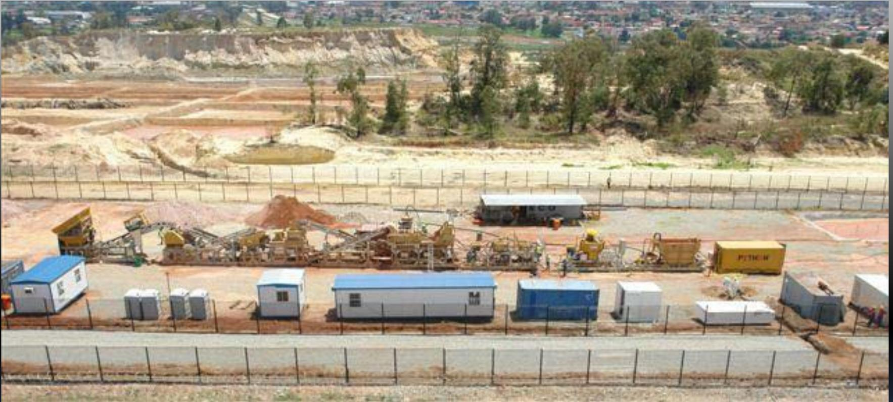
Montage d'une unité Gekko Python (50 t/h) avant installation au fond de la mine
