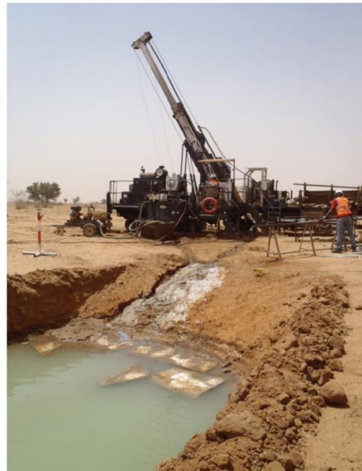
Figure 13. Gauche : *Transport de poubelles de tri sélectifs de déchets sur les sites de sondages Air core.* Droite : *dispositif préventif de contamination des eaux de foration pars serviettes absorbantes* (Clichés : Exploration IAMGold à 'Essakane, Pol Urien, BRGM).
