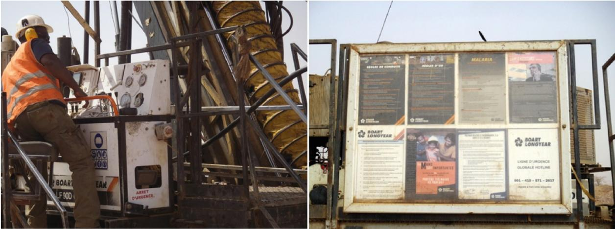
Figure 11. Gauche : Sondeuse équipée de protection des éléments de rotation et d'arrêt d'urgence visibles et accessibles. Opérateur équipé des EPI (Equipement de Protection Individuelle). Droite : Affichage des alertes-sécurité et numéros d'urgence sur la sondeuse (Clichés : Exploration IAMGold à Essakane, Pol Urien, BRGM).
