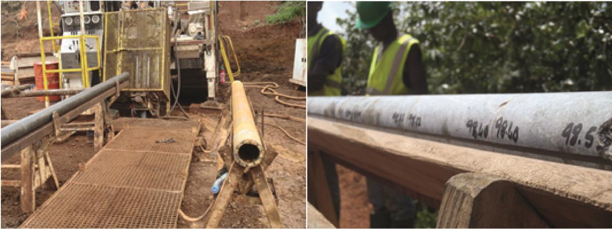
Figure 5. Gauche : Carottier de sondage et caillebotis sur un poste de travail sécurisé. Droite : Contrôle et ajustement des métrages de carottes récupérées sur un poste de travail (Clichés : Mine d'Ity Cominor 2012, Pol Urien, BRGM).
