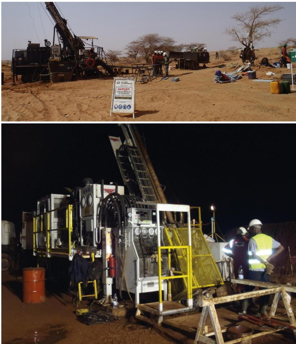
Figure 10. Haut : Aménagement d'une plateforme de sondage carotté avec signalétique d'accès et de sécurité (Exploration IAMGold à Essakane). Bas : Aménagement d'une plateforme de sondage carotté pour le poste de nuit (Exploration Cominor Mine d'Ity). Clichés : Pol Urien, BRGM.
