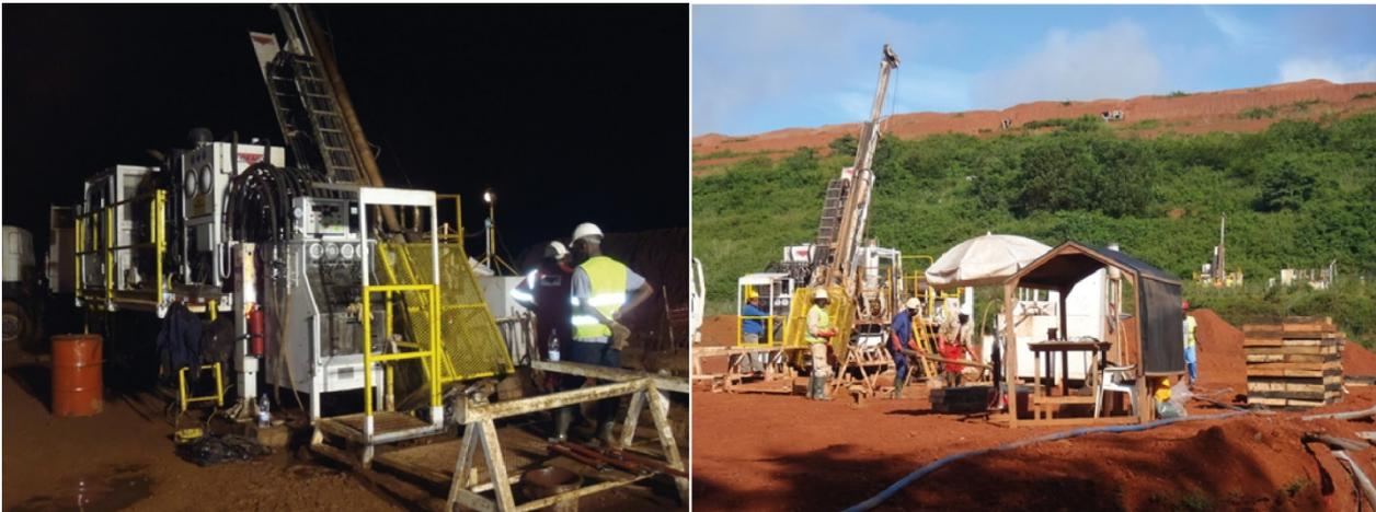
Figure 12. Gauche : Sondeuse équipée de protection des éléments de rotation et éclairage nocturne satisfaisant. Droite : Installation de plateforme en enceinte minière avec abris pour les personnels de suivi (Clichés : Exploration Cominor - Mine d'Ity, Pol Urien, BRGM).
