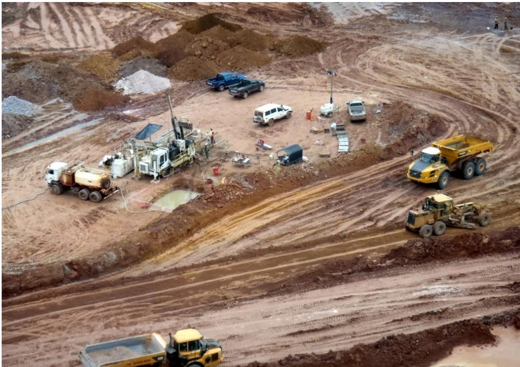
Figure 9 : Réalisation d'un sondage en mine à ciel ouvert, Mine d'Ity Cominor (Cliché : Pol Urien, BRGM).
