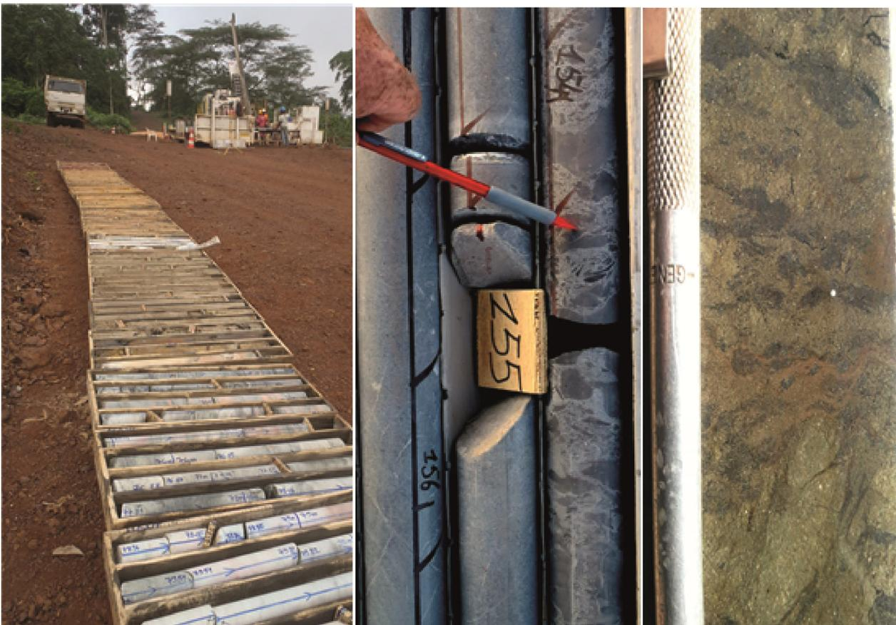
Figure 6. Gauche : Mise en caisse et réalisation de la coupe interprétative du sondage sur le chantier (Cliché : Mine de Ity Cominor 2012, Pol Urien, BRGM). Centre : Vérification des cotes de sondage et repérage des principaux faciès lithologiques (Cliché : Mine d'Essakane IAMGold, Pol Urien, BRGM). Droite : Caractérisation des minerais sulfurés magnétiques (Cliché : Carottes des sondages de Rouez - projet CADI, Pol Urien, BRGM).
