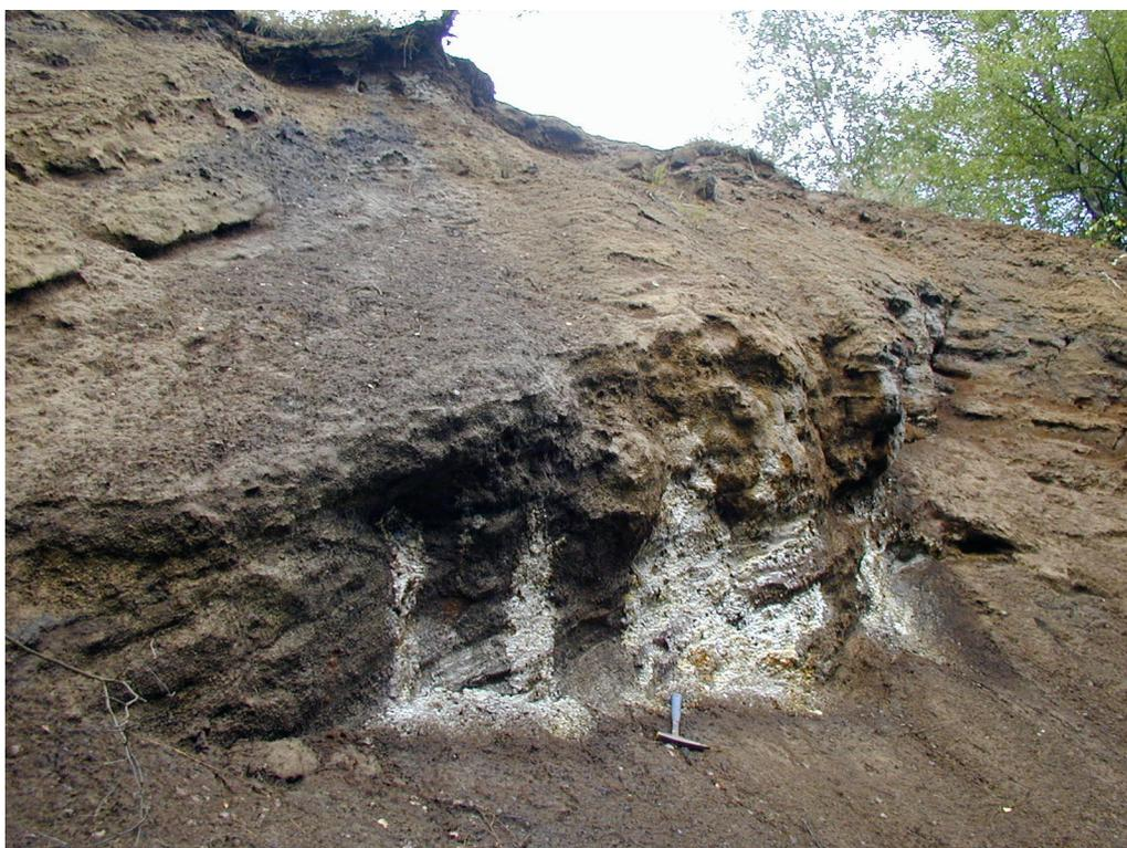
**Phot. 10 - Exemple de minéralogie secondaire (sulfates de fer : mélantérite et sulfates de zinc) dans tailings de l'ancienne mine de Pb/Zn de Pierrefitte (Hautes-Pyrénées).**
