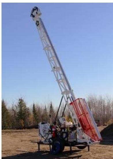
**Figure 2 : Foreuse pour carottage**
