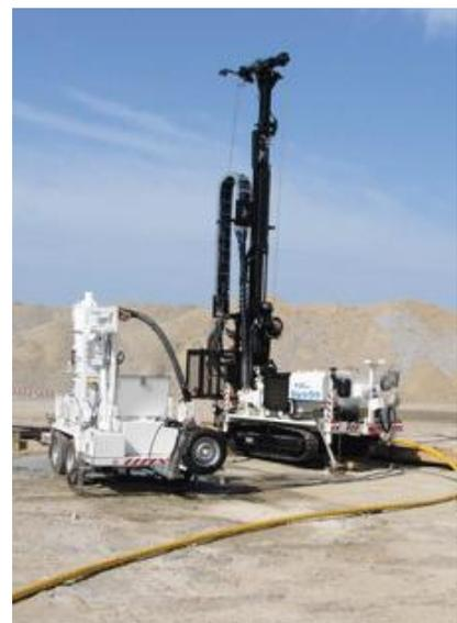
Figure 2 : Foreuse à circulation inverse
