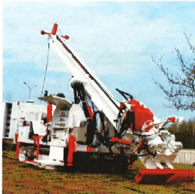
**Figure 2 : Foreuse pour carottage**
