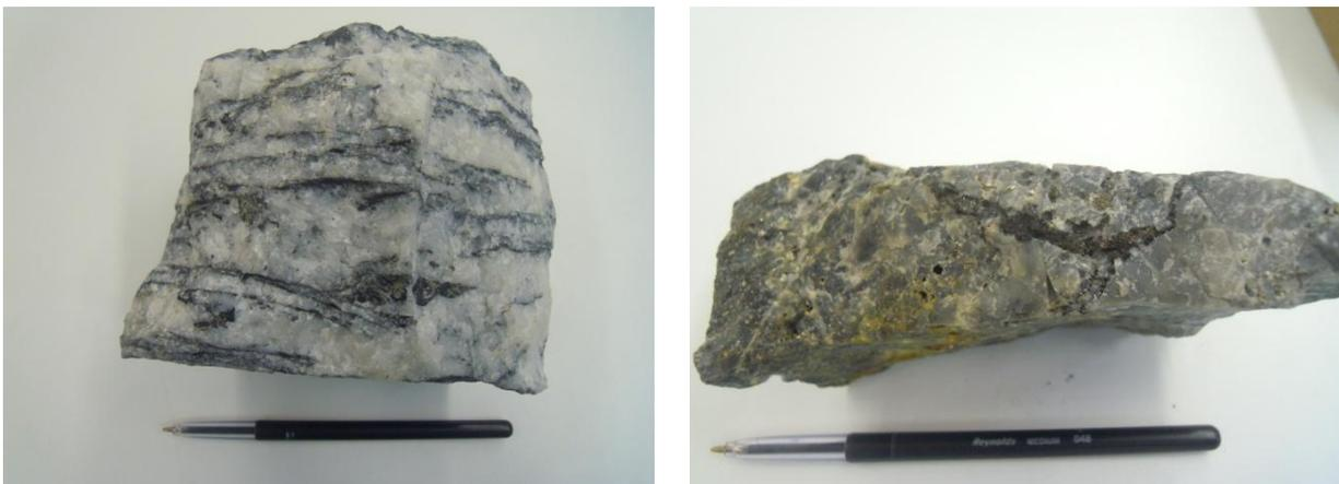
**Figure 7 :** Photographies des échantillons de roches (à gauche, filon de quartz à lamines de schistes noirs. A droite, niveau de chert présentant des disséminations de sulfures).
