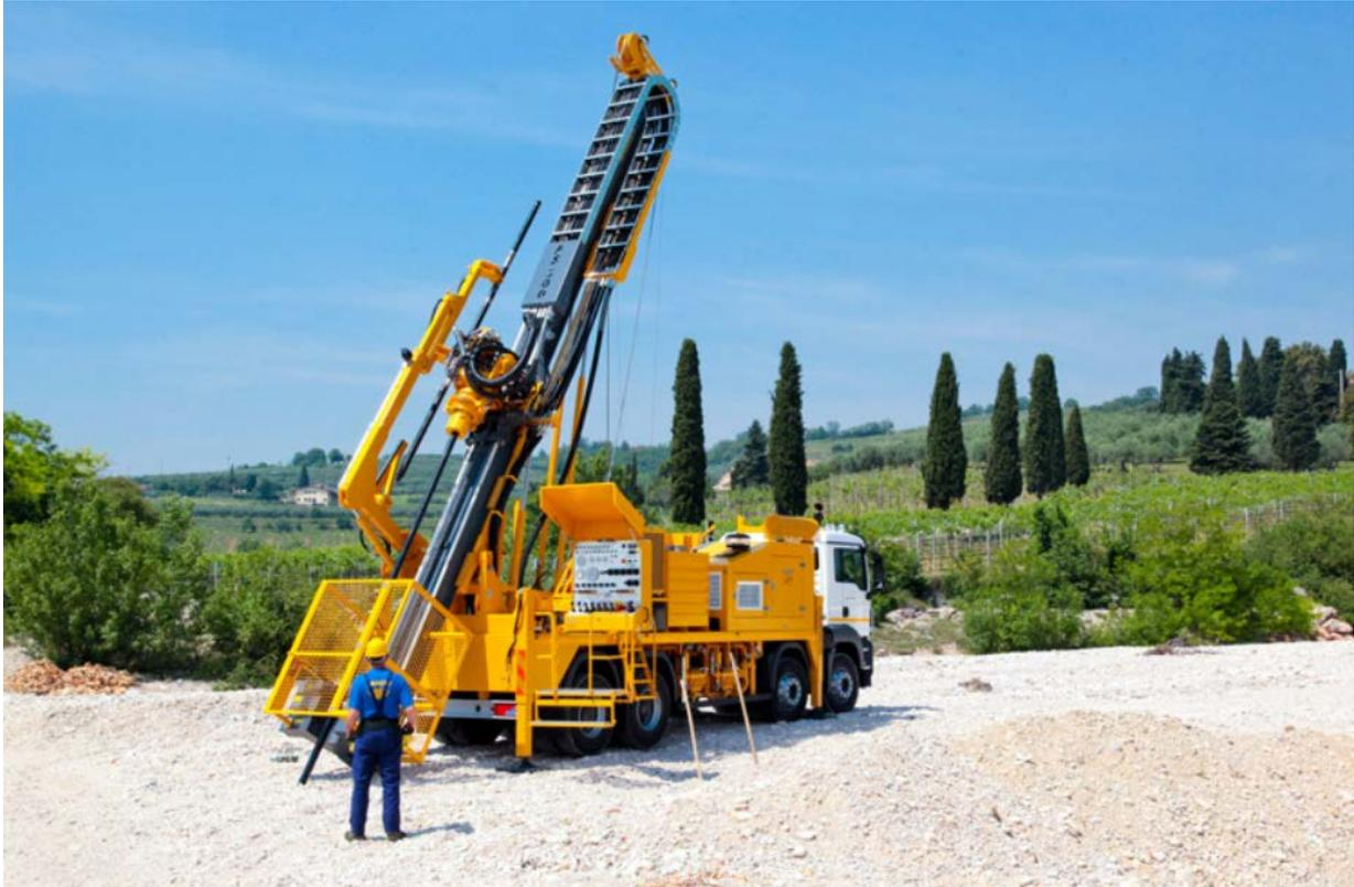
*Vue d'un carottier monté sur camion modèle EXPLORATION-FS-300 (Source : Fraste)*
