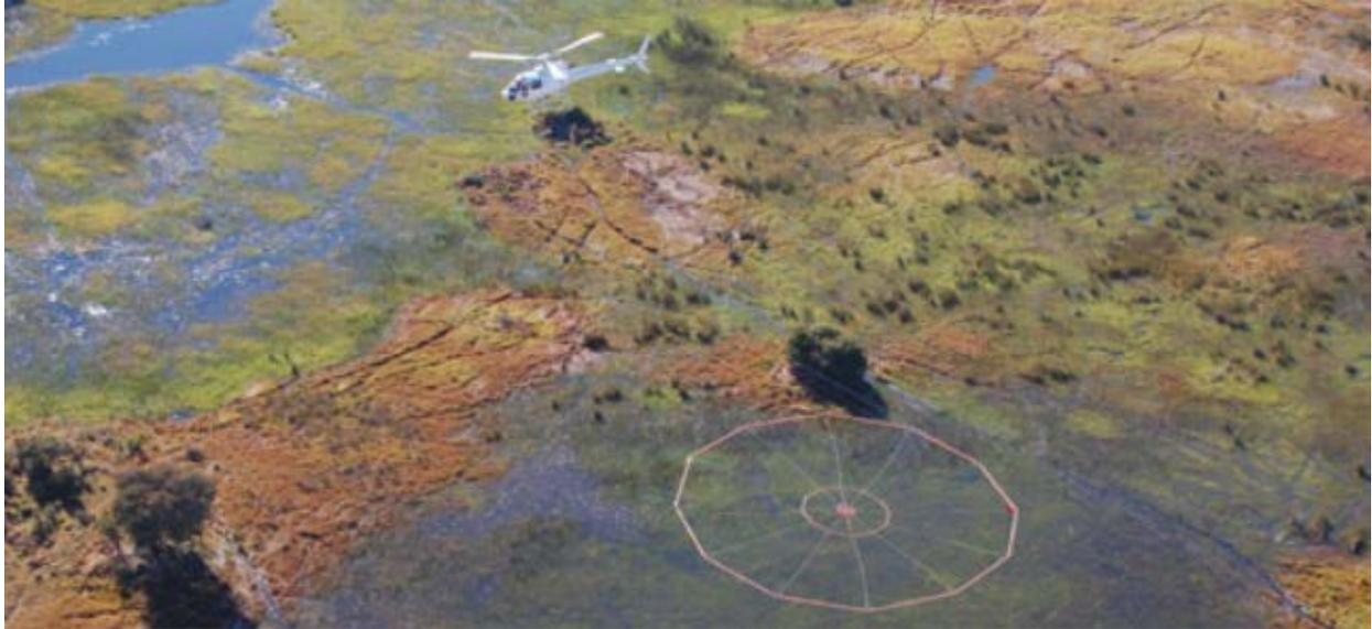
*Levé hélicoptéré VTEM (Source : Geotech)*
