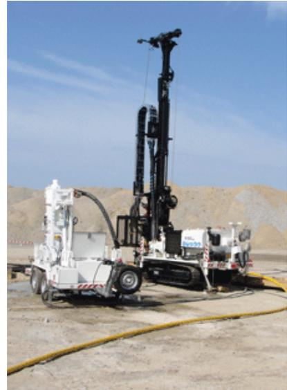
**Figure 3 : Foreuse à circulation inverse**
