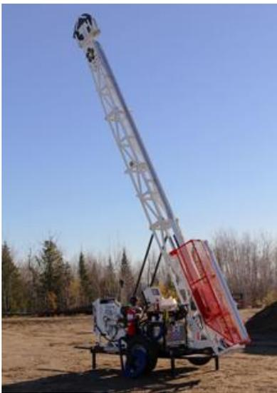
**Figure 4 : Foreuse pour carottage**
