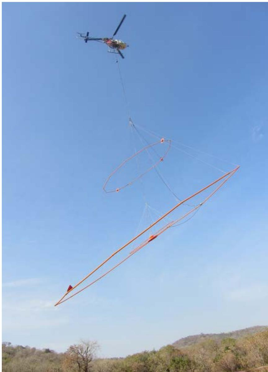
*Photo montrant la méthode géophysique (VTEM) ; et vue du capteur (boucle) héliporté.
