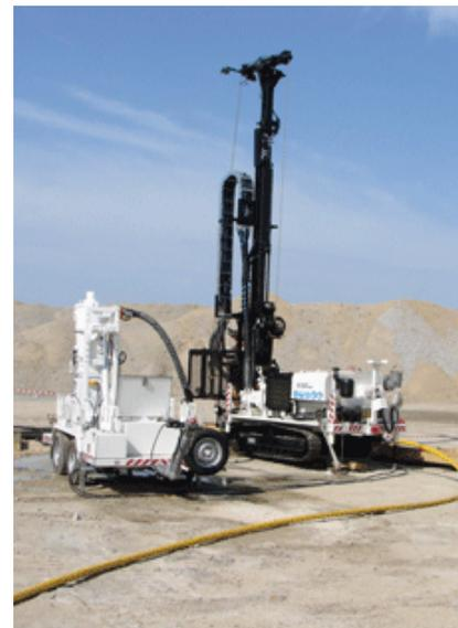
Figure 3 : Foreuse à circulation inverse
