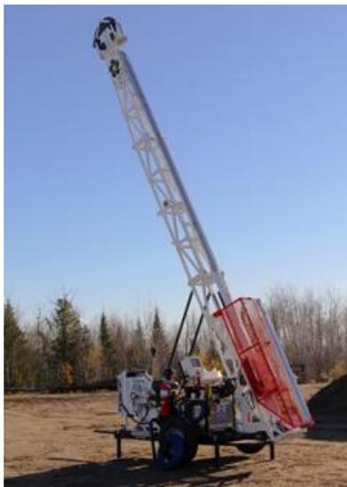
Figure 4 : Foreuse pour carottage
