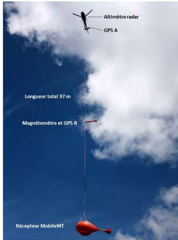
Figure 2 : Schéma de fonctionnement d'un relevé électro-magnétique par antenne MMT sous un hélicoptère (Levé électro-magnétique effectué en 2021 par Aurania sur son permis **d'exploration en Equateur**)
